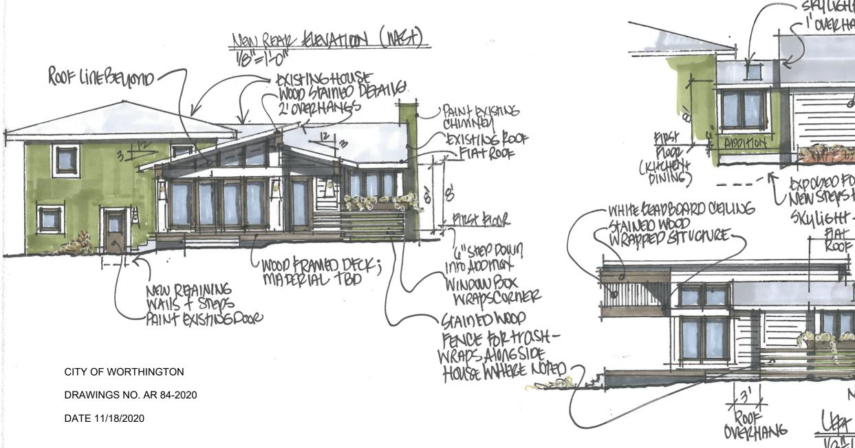
PIGHT ELEVATION (NORTH) WHATE HORIZONIAL BIDING CANTILEVER skylight STAINED NOODWRAPPED STRUCTURE 1'OVERHAM6 SHINGLES - NEW STEPS + RETAINING WALL 1AP ROOF SHINGLES EXISTING HOUSE AT ELEVATION (Gouth)
